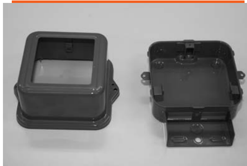
●段差をつける角筒状の深絞り加工をした電力メーターカバー(左)とベース(右)。
